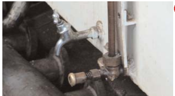
Een waterkraan heeft niets te zoeken op een brandstoftank
