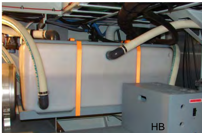
Een vuilwatertank die is ingebouwd door de werf in een schip dat voldoet aan de eisen van de Wet Pleziervaartuigen
