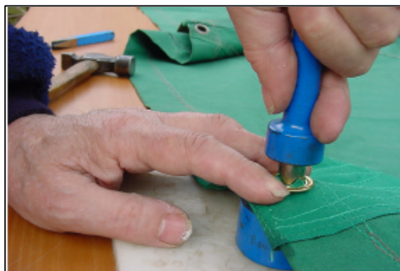
9. De stempel wordt zorgvuldig geplaatst waarbij door voorzichtig schuiven afgetast wordt of de ring exact in de uitsparing van het zadel ligt.
