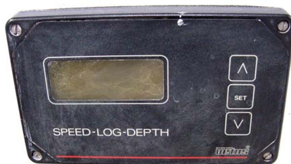
UV is funest geweest. Het apparaat is niet weerbestendig.
