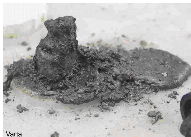
Varta De accuklem zat niet vast...
