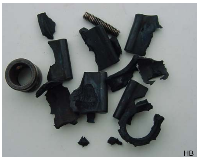
Deze impeller heeft 600 uur dienst gedaan zonder gecontroleerd te zijn. De onderdelen zijn verzameld uit de warmtewisselaar.
