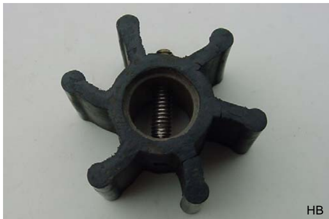
Deze neopreen impeller heeft lang stil gestaan waardoor de rechte schoepen nu een kromme vorm hebben en niet meer goed functioneren. Haal daarom altijd de impeller uit de pomp voor de winterstop en bewaar deze in een afgesloten plastic zakje. Monteren met een beetje zeepsop.
