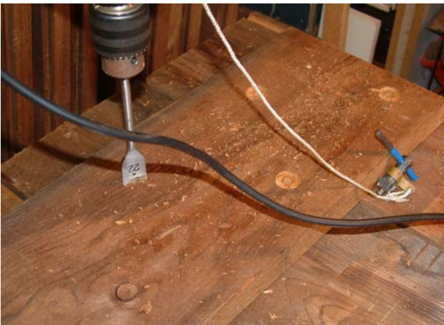
Foto B16 Luik weer omdraaien en de gaatjes op de klamp iets uitboren met een speedboor.
