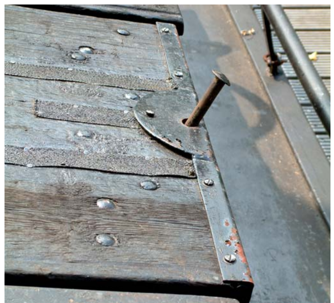
Foto S38 Voorbeeld van een verzegelpen met versterking.
