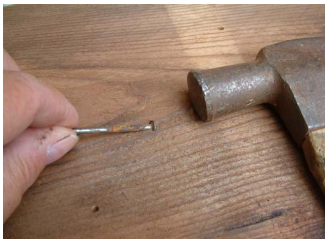
Foto B12 En dan voor het spijkeren eerst de nerf breken tegen het splijten.
