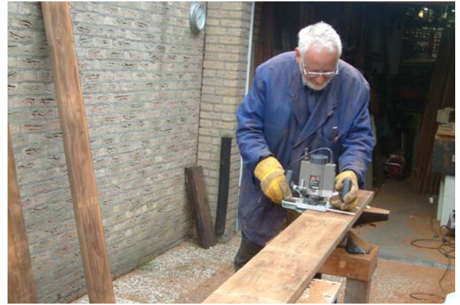
Foto B05 Het frezen van de sponningen en holletjes ging heel soepel met een bovenfrees.
