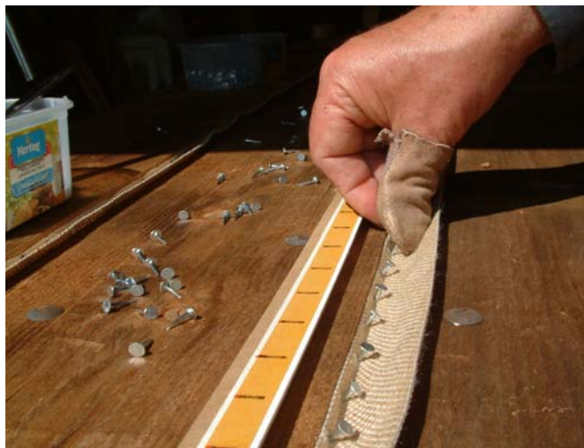
Foto B27 Eerst een rij spijkertjes er met de hand indrukken.
