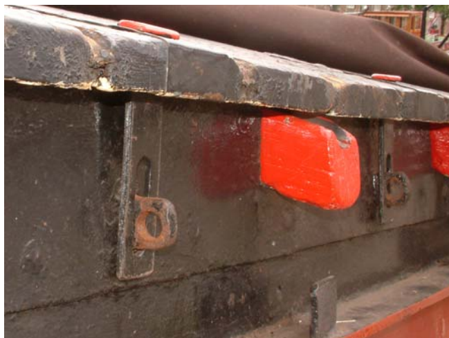
Foto S42 en S43 Voorbeeld van een verzegelstrip parallel aan de den.
