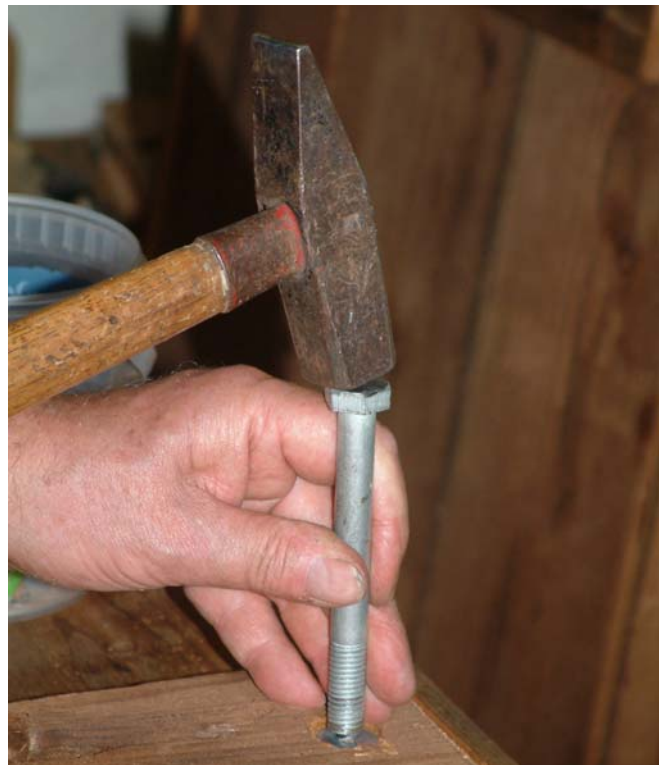
Foto B19 De kop vlakken met een snapper. Hier een flinke bout.
