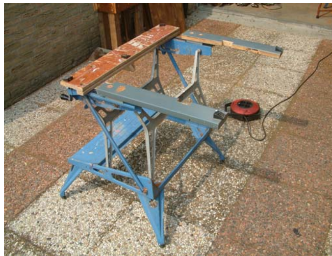
Foto B08 De workmate van lange armen voorzien om de planken te kunnen klemmen.
